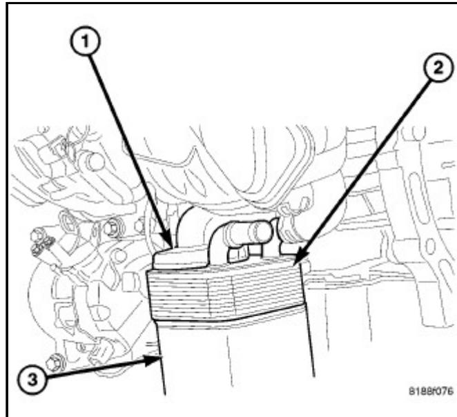
5. 卸下机油冷却器安插件螺栓(2)。
